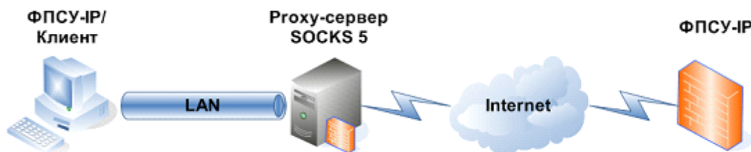
Рисунок 91 - Схема работы ФПСУ-IP/Клиента через Proхy-сервер SOCKS 5
